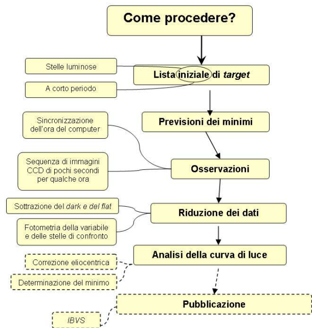
Figura 1. La procedura di base per la fotometria CCD di binarie a eclisse, finalizzata alla pubblicazione degli istanti di minimo. Sono tratteggiate le fasi "non obbligatorie" per gli aderenti alla campagna osservativa.
